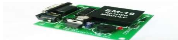
Fig 1.3. EM-18 RFID Reader module
